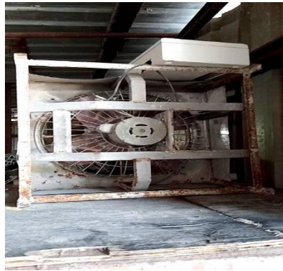
รูปที่ 25 พัดลมระบายอากาศ ทำงานในพื้นที่อับอากาศ
