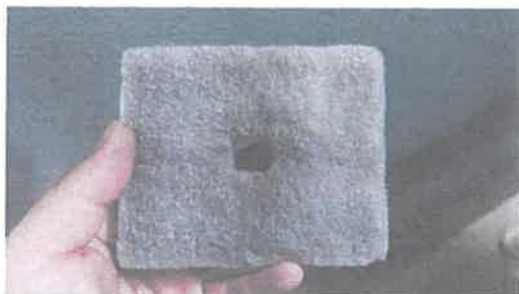
ทำความสะอาดไส้กรองอากาศ และพื้นวางปั๊มโดยรอบ
