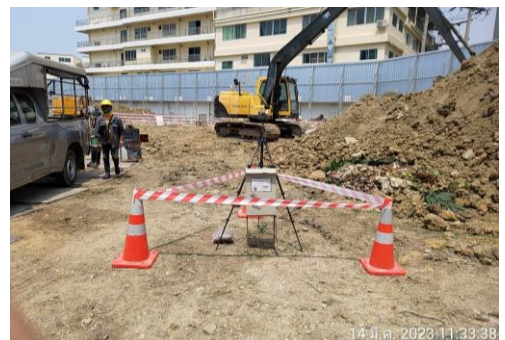
รูปที่ 8 ติดตั้งเครื่องตรวจวัดคุณภาพสิ่งแวดล้อม
