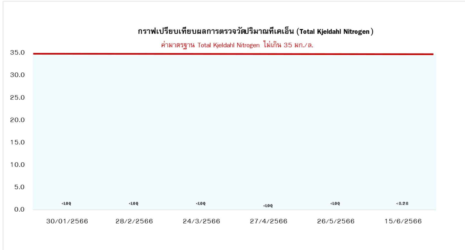
รูปที่ 4-23 กราฟเปรียบเทียบผลการตรวจวัดปริมาณที่เคเอ็น (Total Kjeldahl Nitrogen) บริเวณบ่อกักน้ำสุดท้ายก่อนระบายออกสู่ท่อรับน้ำสาธารณะ
