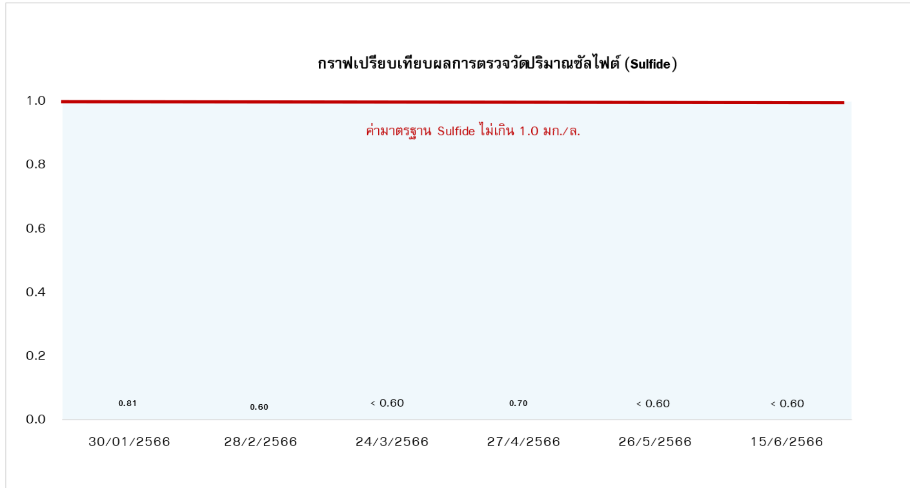
รูปที่ 4-22 กราฟเปรียบเทียบผลการตรวจวัดปริมาณซัลไฟด์ (Sulfide) บริเวณบ่อพักน้ำสุดท้ายก่อนระบายออกสู่ท่อรับน้ำสาธารณะ
