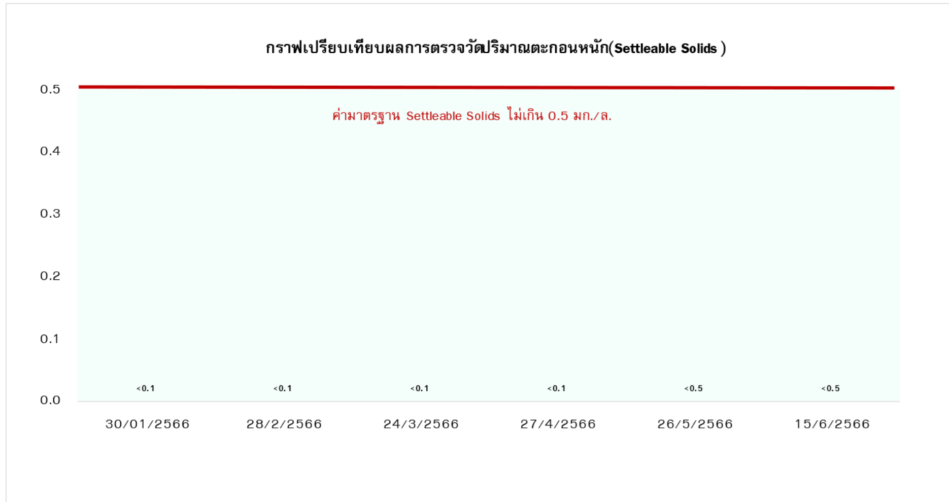
รูปที่ 4-21 กราฟเปรียบเทียบผลการตรวจวัดปริมาณตะกอนหนัก (Settleable Solids) บริเวณบ่อกักน้ำสุดท้ายก่อนระบายออกสู่ท่อน้ำสาธารณะ
