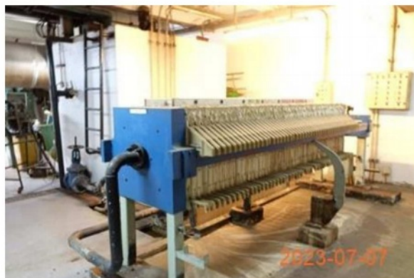
(6) เครื่องรีดตะกอน (Filter Press)
