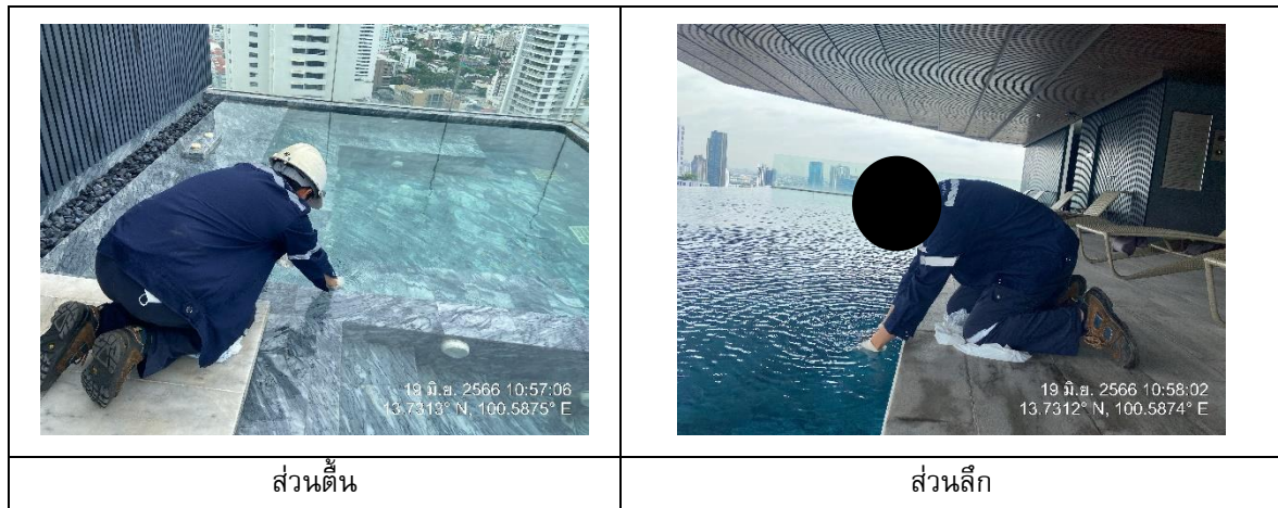
รูปที่ 4.2-1 การเก็บตัวอย่างคุณภาพน้ำสระว่ายน้ำของโครงการ
