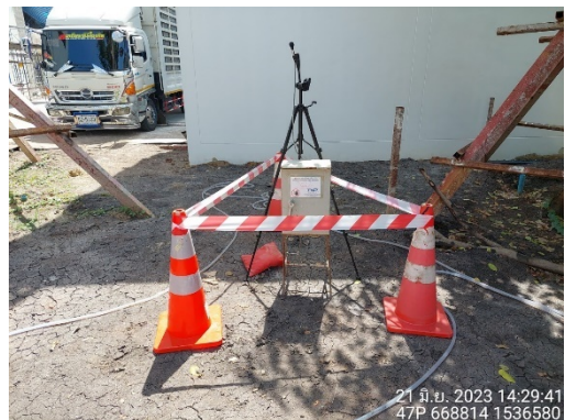
รูปที่ 8 ติดตั้งเครื่องตรวจวัดคุณภาพสิ่งแวดล้อม (คุณภาพอากาศ ระดับเสียง เสียงรบกวน และความสั่นสะเทือน)
