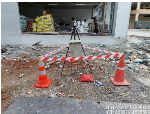
รูปที่ 8 ติดตั้งเครื่องตรวจวัดคุณภาพสิ่งแวดล้อม (คุณภาพอากาศ ระดับเสียง เสียงรบกวน และความสั่นสะเทือน)
