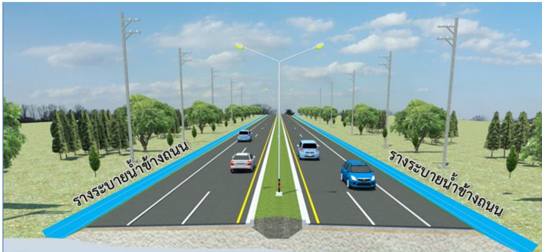
รูปที่ 2-14 รูปตัดแสดงการระบายน้ำระดับดินทั่วไปของโครงการ
