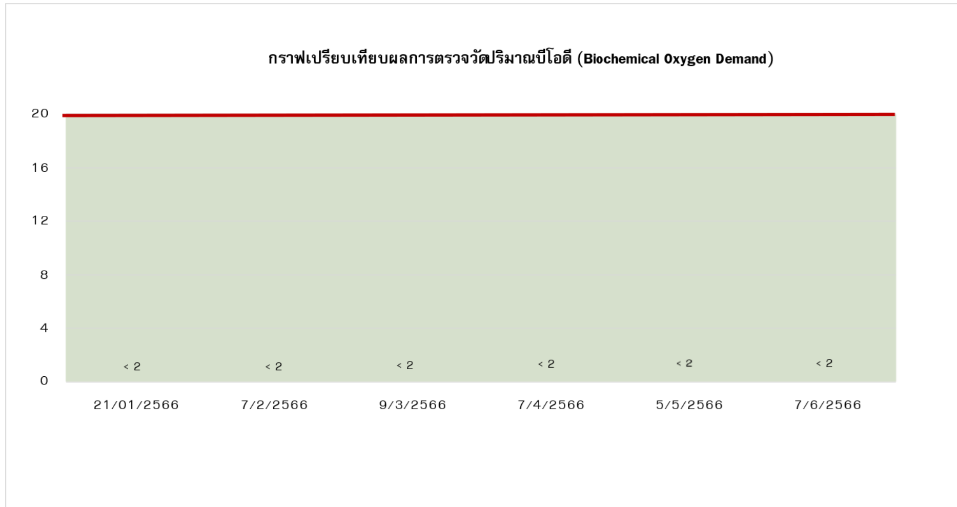
รูปที่ 4-22 กราฟเปรียบเทียบผลการตรวจวัดปริมาณบีโอดี (Biochemical Oxygen Demand)
