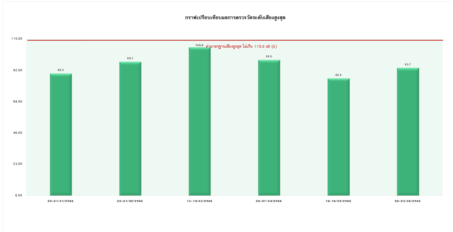
รูปที่ 4-18 กราฟเปรียบเทียบผลการตรวจวัดระดับเสียงสูงสุด บริเวณพื้นที่โครงการ
