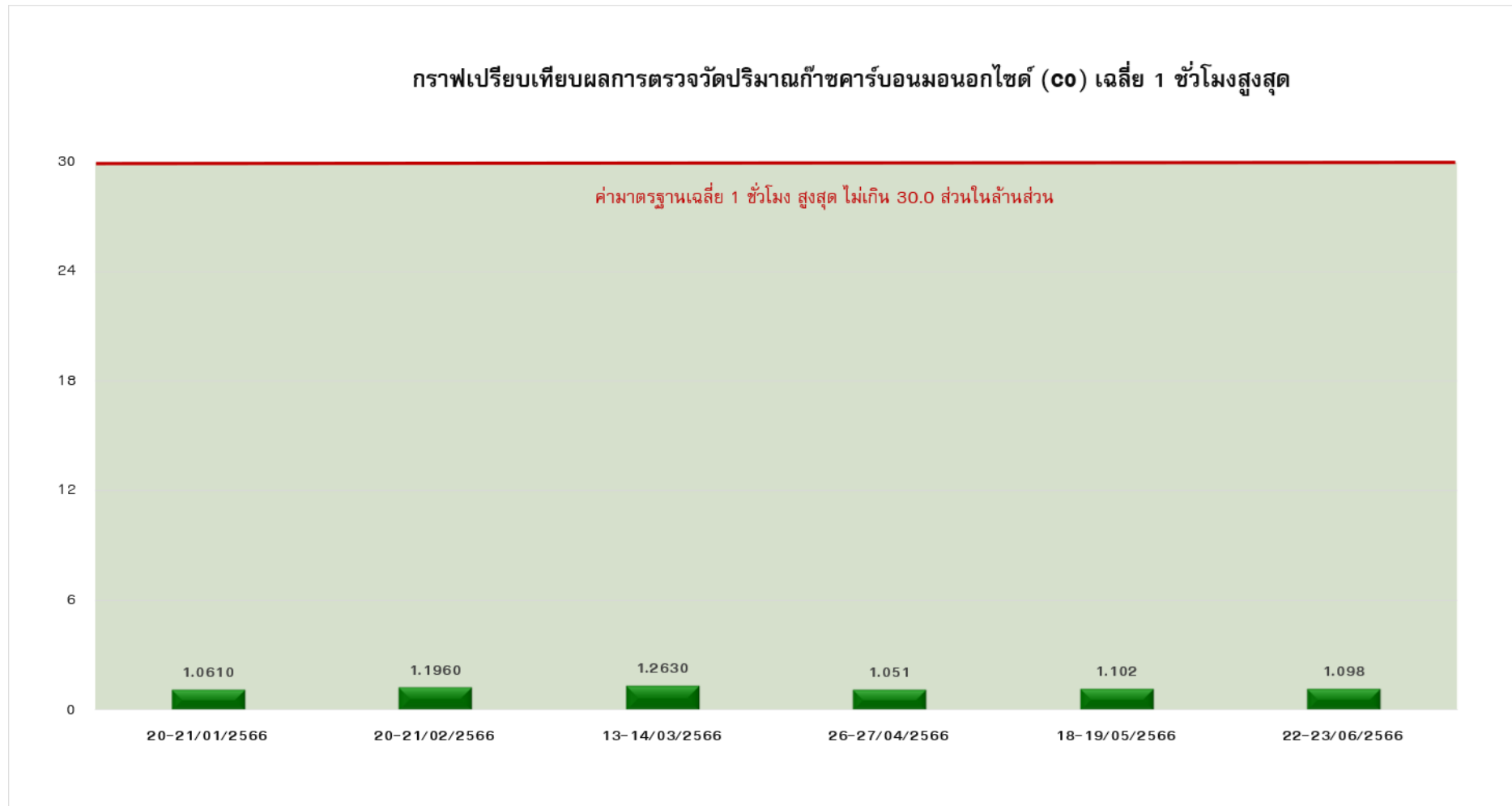
รูปที่ 4-6 กราฟเปรียบเทียบผลการตรวจวัดปริมาณก๊าซคาร์บอนมอนนอกไซด์ (CO) เฉลี่ยในเวลา 1 ชั่วโมง บริเวณพื้นที่โครงการ
