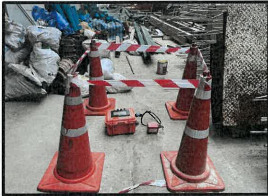
รูปที่ 3-13 ติดตั้งเครื่องวัดความสั่นสะเทือนในพื้นที่ก่อสร้าง
