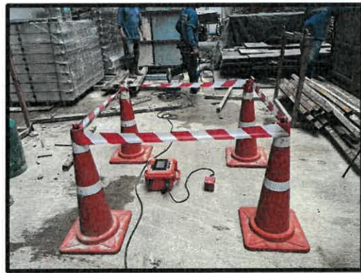
รูปที่ 3-13 ติดตั้งเครื่องวัดความสั่นสะเทือนในพื้นที่ก่อสร้าง
