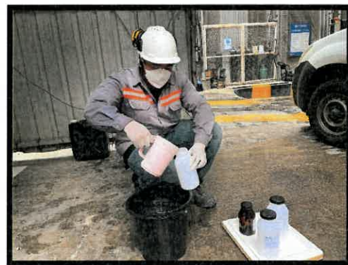
รูปที่ 4.3.4-8 แสดงการเก็บตัวอย่างน้ำทิ้ง บริเวณบ่อกักน้ำทิ้งก่อนปล่อยออกนอกโครงการ
