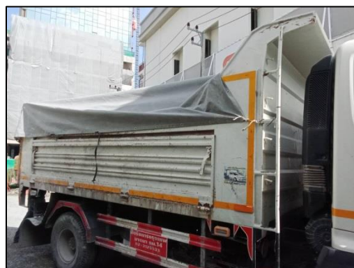
รูปที่ 35 การคลุมรถบรรทุกที่ใช้ขนส่งวัสดุก่อสร้าง ด้วยผ้าใบอย่างมิดชิด
