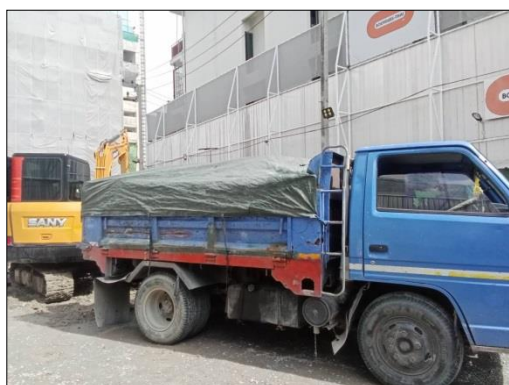
รูปที่ 35 การคลุมรถบรรทุกที่ใช้ขนส่งวัสดุก่อสร้าง ด้วยผ้าใบอย่างมิดชิด
