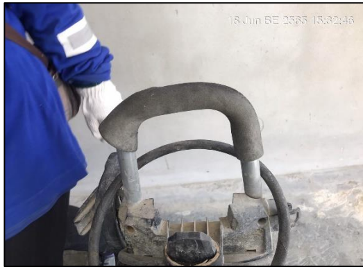
รูปที่ 81 วัสดุป้องกันและดูดซับการสั่นเพื่อลดการสั่นของเครื่องมือ
