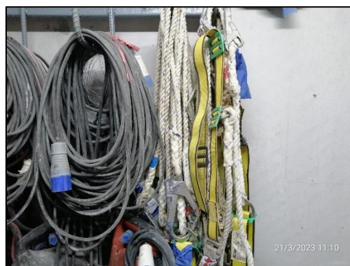
รูปที่ 52 อุปกรณ์ช่วยชีวิต สายหรือเชือกช่วยชีวิต และเช็ดขัดนิรภัย
