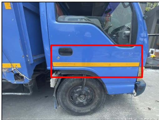
รูปที่ 36 ไฟสี และแถบสีสะท้อนแสงที่รถบรรทุก
