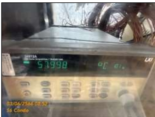
ภาพที่ 77 การวัดอุณหภูมิขณะเทคอนกรีตงานฐานราก
