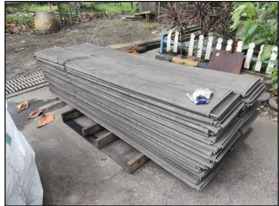
รูปที่ 8 การเปลี่ยนถุงกรอง (Bag Filter)
