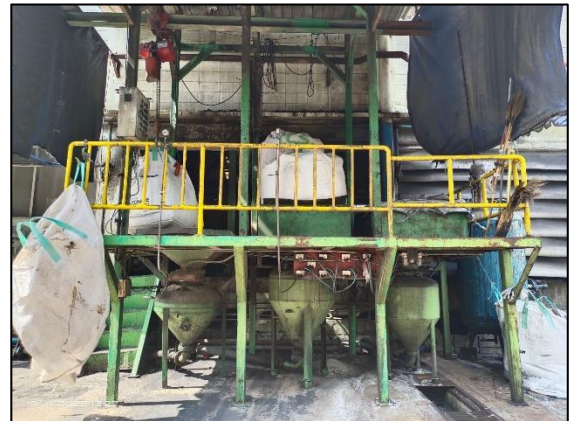
รูปที่ 3 ระบบไซโคลน (Cyclone)
