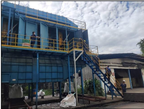
รูปที่ 8 การเปลี่ยนถุงกรอง (Bag Filter)
