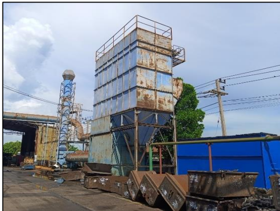
รูปที่ 2 ระบบดักฝุ่นแบบถุงกรอง (Dust Collector)
