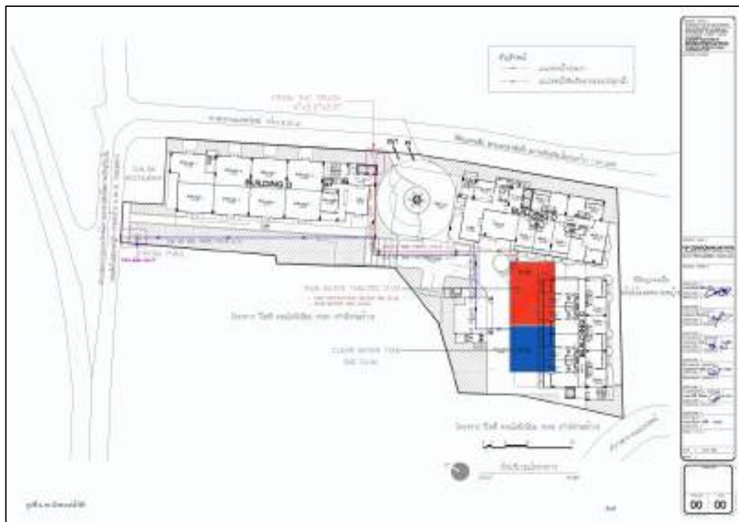
รูปที่ 1.5 แผนผังระบบน้ำใช้
