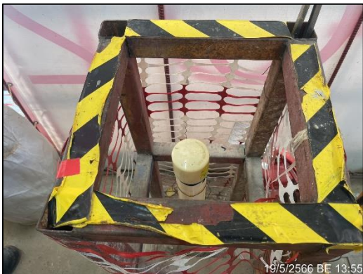
ภาพที่ 26 เครื่องมือตรวจวัดการเคลื่อนตัวของดิน
