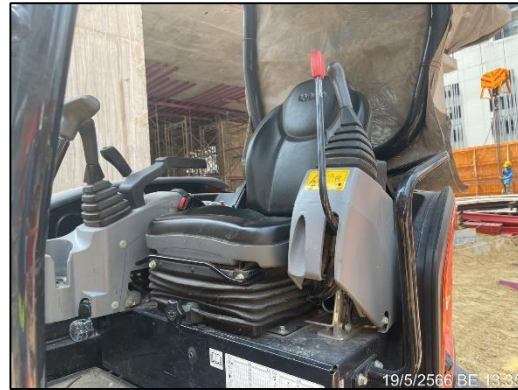
ภาพที่ 27 เบาะลดการสั่นสะเทือนของเครื่องจักร
