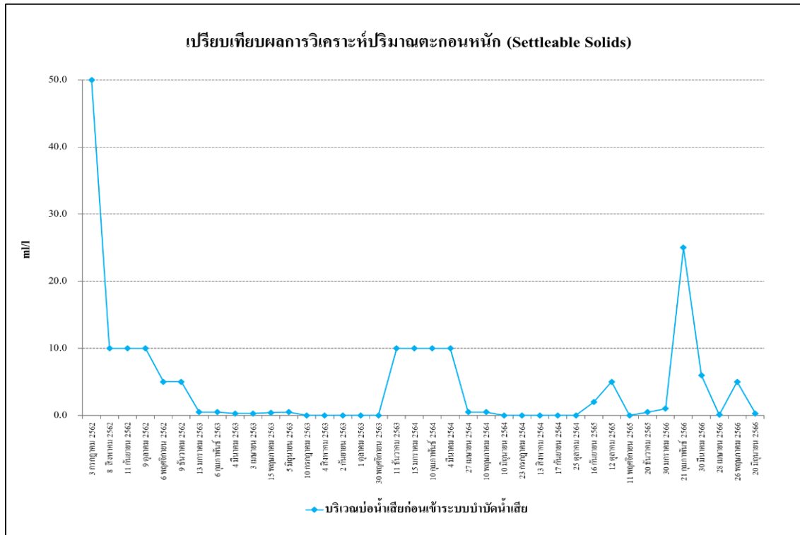
รูปที่ 4.4-24 เปรียบเทียบผลการวิเคราะห์ปริมาณตะกอนหนัก (Settleable Solids) บริเวณบ่อน้ำเสียก่อนเข้าระบบบำบัด ระหว่างเดือนกรกฎาคม 2562-มิถุนายน 2566
