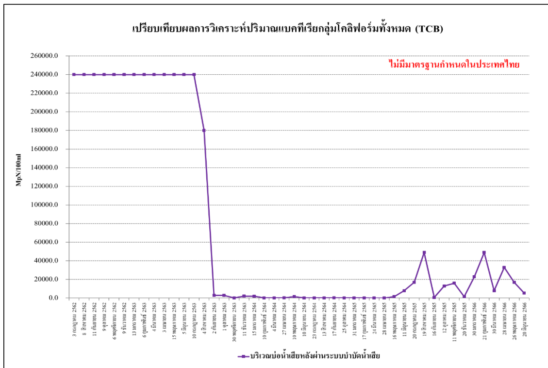
รูปที่ 4.4-37 เปรียบเทียบผลการวิเคราะห์ปริมาณแบคทีเรียกลุ่มโคลิฟอร์มทั้งหมด (TCB) บริเวณบ่อน้ำเสียหลังผ่านระบบบำบัด ระหว่างเดือนกรกฎาคม 2562-มิถุนายน 2566
