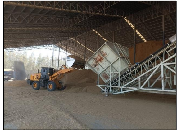
รูปที่ 14 การใช้รถดักล้อยาง (Front Loader) ดักแกลบใส่รถสายพานลำเลียง
