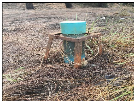
รูปที่ 30 บ่อติดตามตรวจสอบน้ำใต้ดิน
