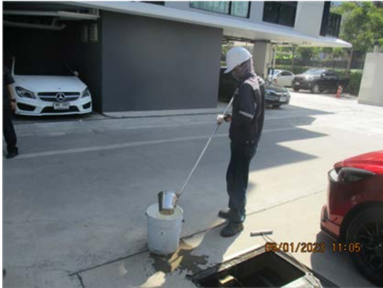
รูปที่ 3-3 การเก็บตัวอย่างคุณภาพน้ำทิ้ง บริเวณบ่อสูบน้ำทิ้งหลังการบำบัด อาคาร A-D
