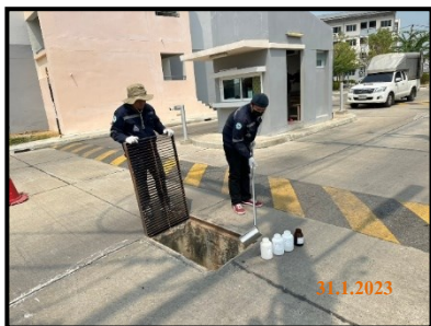
บ่อกักน้ำทิ้งหลังออกจากระบบบำบัดน้ำเสียรวม
