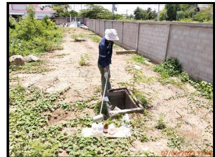
บ่อตรวจวัดคุณภาพน้ำก่อนระบายออก จากโครงการ ส่วนที่ 3
