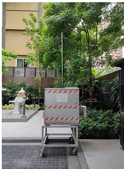
ภาพที่ 5 ติดตั้งเครื่องตรวจวัดก๊าซมลพิษทางอากาศ \text{CO}_2 , \text{SO}_2 , \text{NO}_2 , \text{HC}
