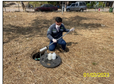
บ่อบักน้ำทิ้งหลังผ่านการบำบัดของระบบบำบัดน้ำเสียใน พื้นที่โซนที่ 3
