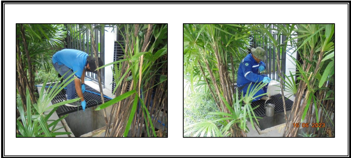
รูปที่ 3.1-1 จุดตรวจวัดคุณภาพน้ำทิ้ง บริเวณบ่อตรวจคุณภาพน้ำทิ้งหลังการบำบัดน้ำเสีย
