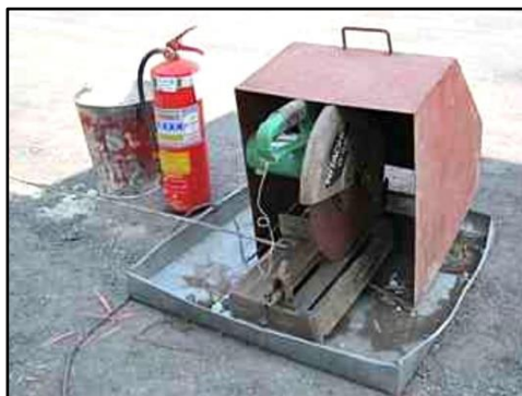
รูปที่ 50 กำบังสะเก็ดไฟเชื่อมต่อโลหะ และตัดโลหะ
