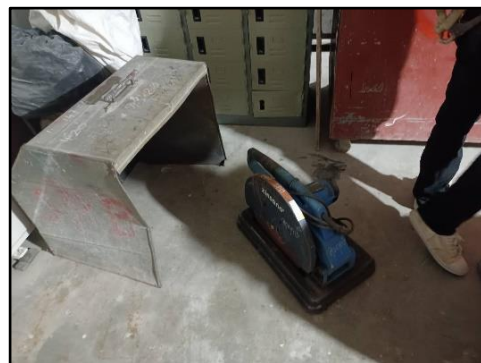
รูปที่ 50 กำบังสะเก็ดไฟเชื่อมต่อโลหะ และตัดโลหะ
