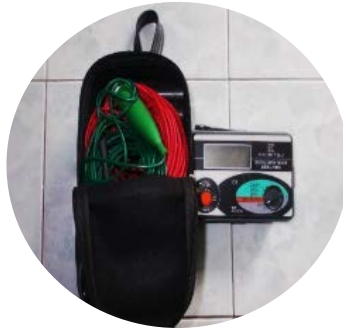
เครื่องวัดความต้านทานดินแบบอนาล็อก ใช้วัดความต้านทานดินของระบบป้องกันฟ้าผ่า
