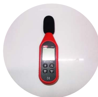
เครื่องความดังของเสียง ใช้ตรวจวัดความดังของ เสียงระบบแจ้งเหตุเพลิงไหม้
