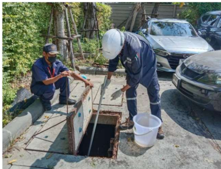
รูปที่ 9 (ต่อ) การเก็บตัวอย่างน้ำทิ้งของระบบบำบัดของโครงการ
