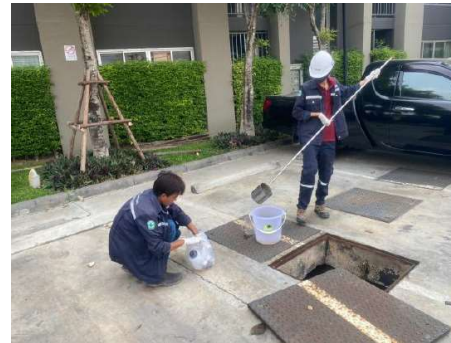
รูปที่ 9 การเก็บตัวอย่างน้ำทิ้งของระบบบำบัดของโครงการ
