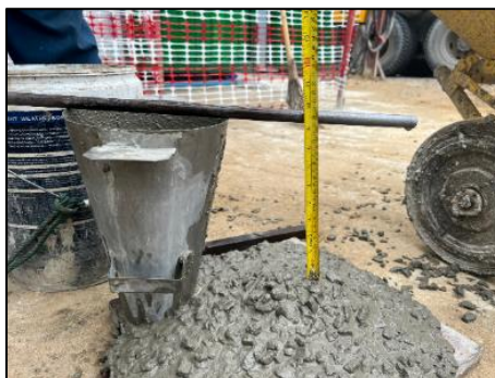
รูปที่ 73 ตรวจวัดค่าการยุบตัว และอุณหภูมิของคอนกรีต
