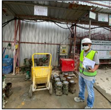
รูปที่ 74 เจ้าหน้าที่เก็บตัวอย่างคอนกรีต (ลูกปูน)
