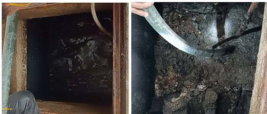
ภาพที่ 3-36 สุ่มตะกอนที่บ่อเก็บตะกอนระบบบำบัดน้ำเสีย
