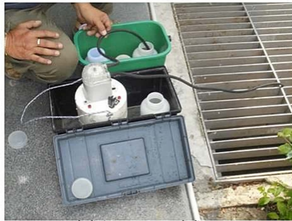
การเก็บตัวอย่างน้ำทิ้งที่บ่อตรวจสอบคุณภาพน้ำทิ้ง แบบ Sample Pump
