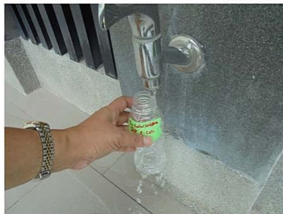
การเก็บตัวอย่างจากก๊อกน้ำใช้ บ่อสำรองน้ำใช้ของโครงการหาค่าเชื้อ E.Coli
