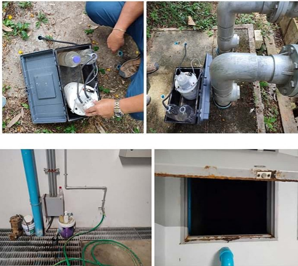
ภาพที่ 4 เก็บตัวอย่างน้ำทิ้งที่บ่อตรวจคุณภาพน้ำ และน้ำใช้จากบ่อสำรองน้ำใช้ใต้ดิน
