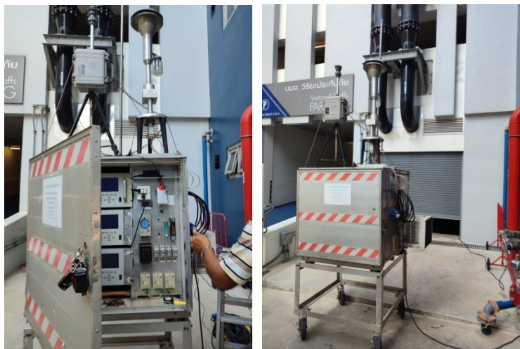
ภาพที่ 6 เก็บตัวอย่างคุณภาพอากาศภายในพื้นที่โครงการ
