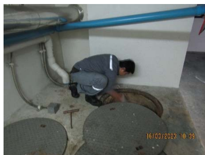
ภาพที่ 3.5-1 การเก็บตัวอย่างน้ำทิ้งจากโครงการ
