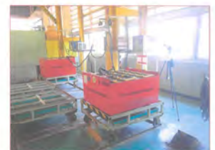
รูปที่ 32 การตรวจวัด Sulfuric acid ( H_2SO_4 ) บริเวณ Warehouse (ชาร์ตแบดเคอรี่ Fork Lift)
