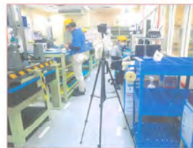
รูปที่ 29 การตรวจวัด Hydrochloric acid บริเวณ Inspection 1
