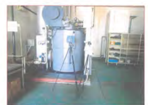
รูปที่ 34 การตรวจวัด Sodium hydroxide บริเวณ Boiler Room
