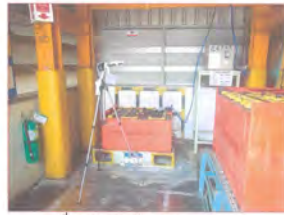
รูปที่ 31 การตรวจวัด Sulfuric acid ( H_2SO_4 ) บริเวณ ชาร์จแบตเตอรี่ Fork Lift
