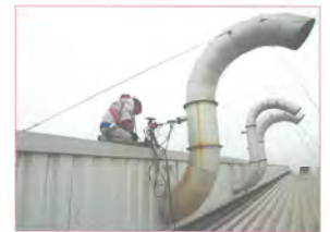
รูปที่ 6 การตรวจวัด TSP, SO 2 , NO 2 , CO, CO 2 และ Propane บริเวณปล่อย Pre Heat (Old)
