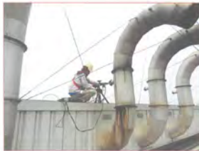
รูปที่ 9 การตรวจวัด TSP, SO 2 , NO 2 , CO, CO 2 และ Propane บริเวณปล่อย Templing
