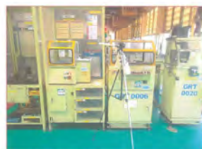
รูปที่ 26 การตรวจวัด Nitric acid และ Phenol บริเวณ HT1
