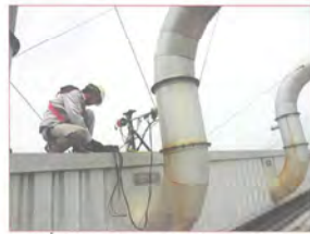
รูปที่ 8 การตรวจวัด TSP, SO 2 , NO 2 , CO, CO 2 และ Propane บริเวณปล่อย Entrance Burner (Furnace 4,5,6)
