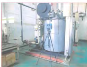
รูปที่ 48 การตรวจวัดระดับความร้อน (Heat Stress) บริเวณ Boiler Room : คุณณรงค์เดช
