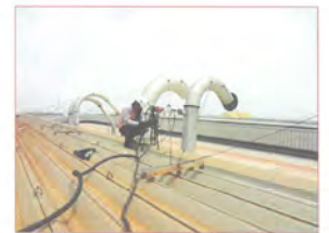
รูปที่ 2 การตรวจวัด Sodium Hydroxide (NaOH) บริเวณปล่อย Pre-Washer
