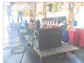
รูปที่ 31 การตรวจวัด Manganese และ Silica บริเวณ PM Shop (พื้นที่เชื่อม)
