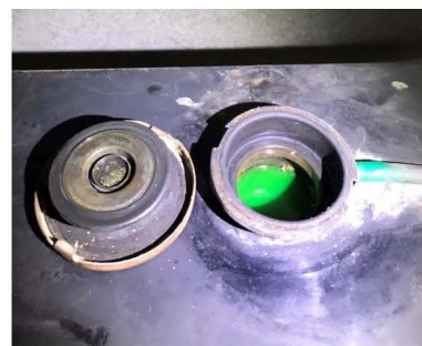
ขณะทำการตรวจเช็คระดับน้ำในหม้อน้ำ
