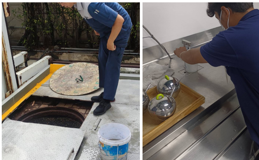
ภาพที่ 5 เก็บตัวอย่างน้ำทิ้งที่บ่อตรวจคุณภาพน้ำทิ้ง
