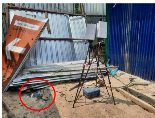
รูปที่ 3.41 การตรวจวัดความสั่นสะเทือน บริเวณพื้นที่โครงการ
