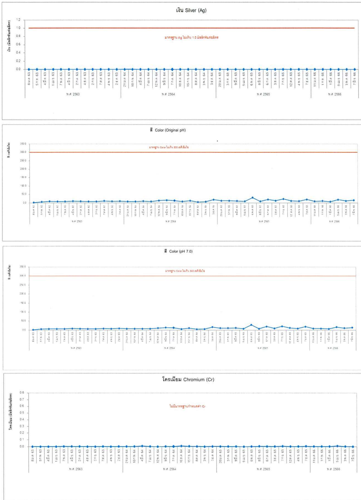
รูปที่ 3.4.6-3 (ต่อ) กราฟเปรียบเทียบผลการวิเคราะห์คุณภาพน้ำทิ้งที่ Inspection Manhole ระหว่างปี พ.ศ. 2563-2566
