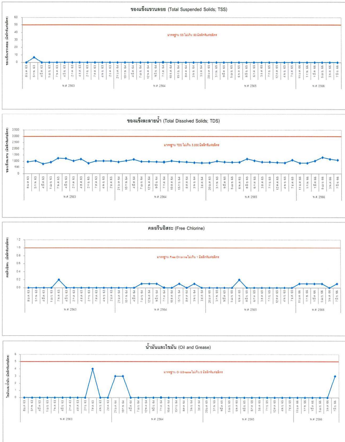
รูปที่ 3.4.6-3 (ต่อ) กราฟเปรียบเทียบผลการวิเคราะห์คุณภาพน้ำทิ้งที่ Inspection Manhole ระหว่างปี พ.ศ. 2563-2566
