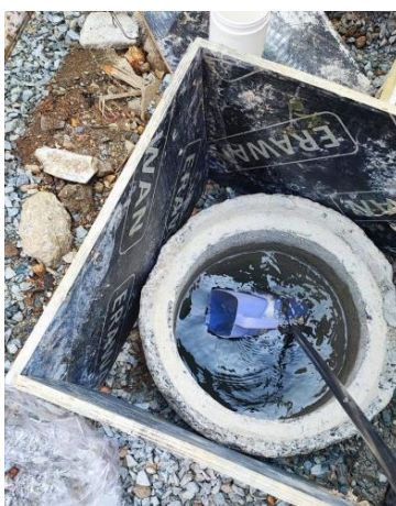
รูปที่ 3.28 การเก็บตัวอย่างคุณภาพน้ำทิ้ง
