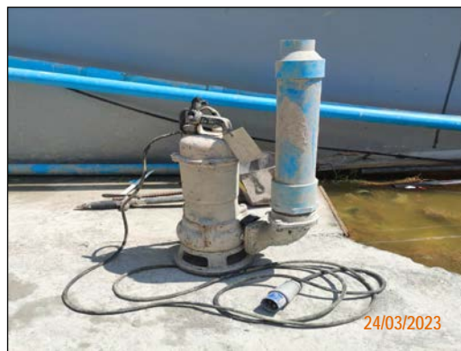
ภาพที่ 2.2-17 เครื่องสูบน้ำประจำพื้นที่ก่อสร้าง
