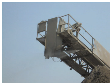
รูปที่ 2-22: ระบบฉีดสเปรย์น้ำในโรงโม่หิน
