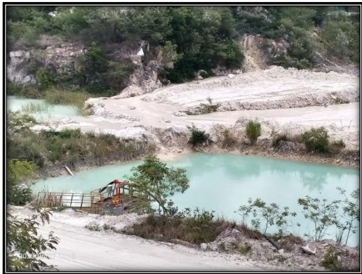
รูปที่ 2-38 บ่อรองรับน้ำ (Sump) พร้อมเครื่องสูบน้ำไปบ่อดักตะกอน
