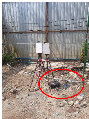
รูปที่ 3.16 การตรวจวัดความสั่นสะเทือนภายในพื้นที่โครงการ
