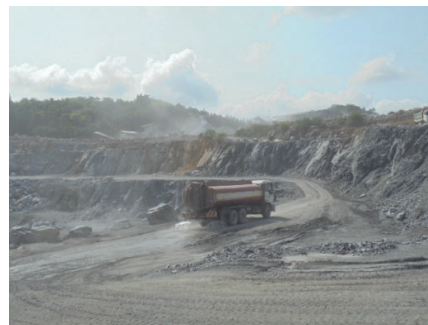
รูปที่ 2-14: การฉีดพรมน้ำหน้าเหมือง
