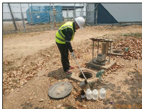
บ่อกักน้ำหลังผ่านระบบบำบัดน้ำเสียอาคารที่พักผู้โดยสาร ชุดที่ 3
