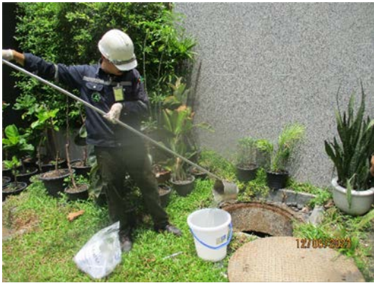
รูปที่ 3-5 คุณภาพน้ำทิ้งก่อนการบำบัด บริเวณบ่อปรับสภาพน้ำพร้อมตะแกรงดักขยะ
