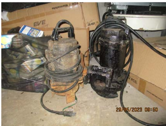
รูปที่ 2-14 อุปกรณ์สำรองระบบบำบัดน้ำเสีย
