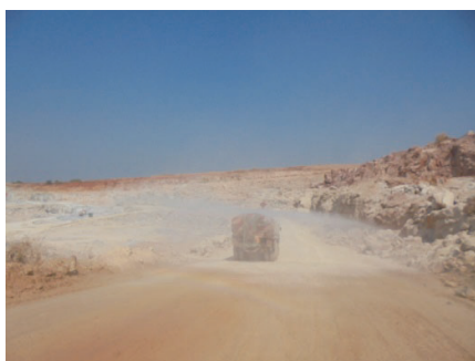
รูปที่ 2-40: การฉีดพรมน้ำหน้าเหมือง
