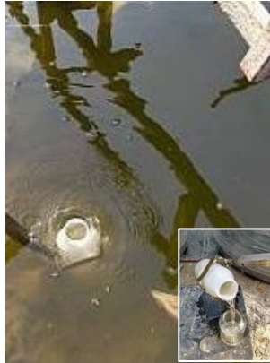
รูปที่ 3.42 การเก็บตัวอย่างคุณภาพน้ำทิ้ง บริเวณระบบบำบัดน้ำเสียสำเร็จรูป
