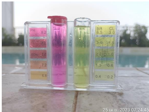
ภาพที่ 54 เจ้าหน้าที่ตรวจวัดค่าความเป็นกรด-ด่าง และปริมาณคลอรีน
