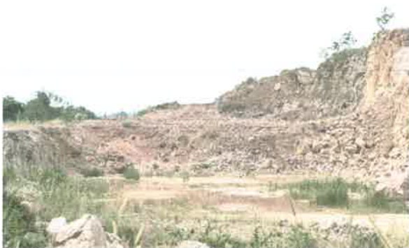
รูปที่ 2 การเปิดหน้าเหมืองเป็นชั้นบันได บริเวณตอนกลางของประทานบัตร
