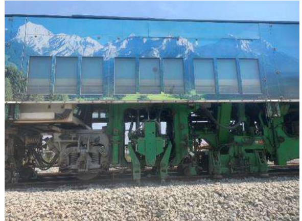
รูปที่ 1-31 งานบดอัด Ballast และจัดระดับทางรถไฟ
